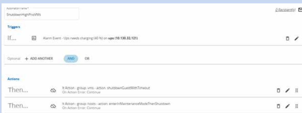
Obraz 6: Konfiguracja automatyzacji IPM do zamykania klastra- wyłączenie kluczowych maszyn wirtualnych, a następnie serwerów ESXi, gdy poziom naładowania baterii UPS spadnie poniżej 40%
